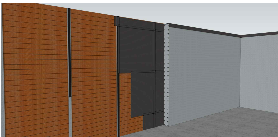
Rys. 1.3. IZOLACJA ŚCIANKI BERLIŃSKIEJ - WIDOK
